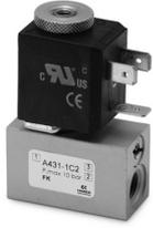
L'elettrovalvola 3/2 vie NC, con attacchi da G1/8, è stata realizzata con un piccolo scarico rapido incorporato. È particolarmente adatta all'azionamento di piccoli cilindri a semplice effetto.
